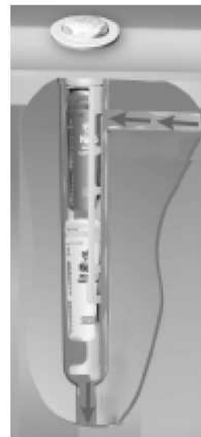
Corte transversal de los cartuchos ubicados dentro del soporte y ubicados en el Sistema construido dentro de la línea
