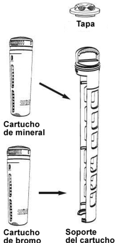
Corte transversal de los cartuchos ubicados dentro del soporte y ubicados en el Sistema construido dentro de la línea
