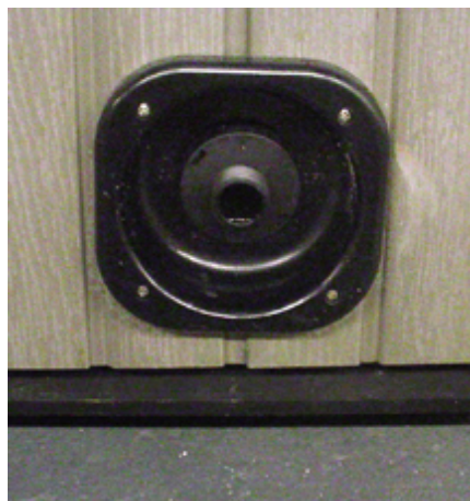
Figure 17. Soupape de drainage montée sur la jupe
